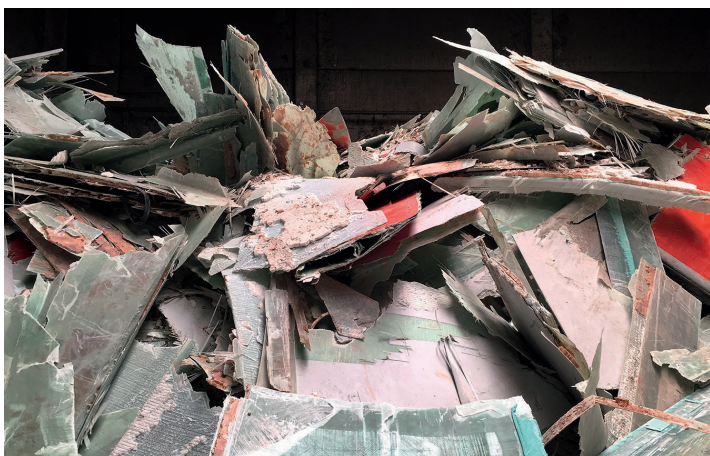
Bild 5. Demontierte Rotorblätter ersetzen traditionelle Ressourcen: Nach Grobzerkleinern und Shredern dienen sie als Brennstoffmaterial und Rohsandsubstitut in Zementwerken
