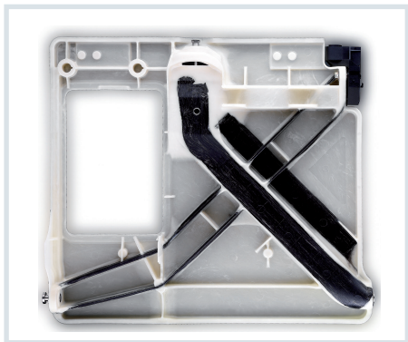
Bild 4. Pkw-Rückenlehnenkomponente in E-LFT-Technik aus compoundiertem PA 6 GF 40 mit 10 mm langen Glasfasern und entsprechend der Lastfälle positionierten unidirektionalen Pultrusionsprofilen (© Weber Fibertech)
